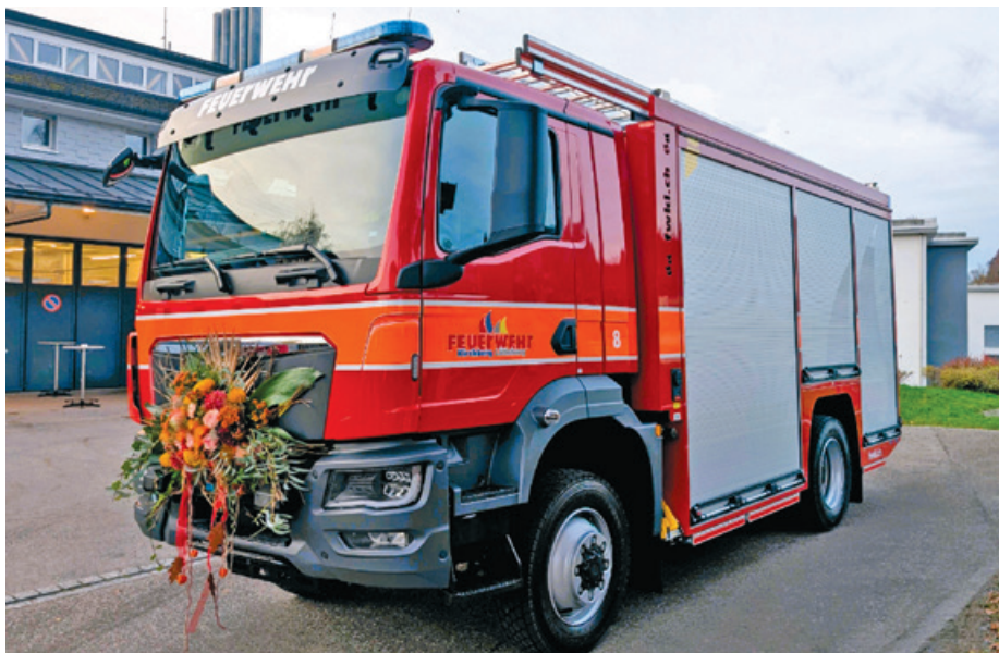
Unser neues Tanklöschfahrzeug. Ausgestattet unter anderem mit 2'500 l Wassertank, leistungsstarker Pumpe, Atemschutz-, Schlauch- und Pioniermaterial zur Brandbekämpfung und technischen Hilfeleistung
