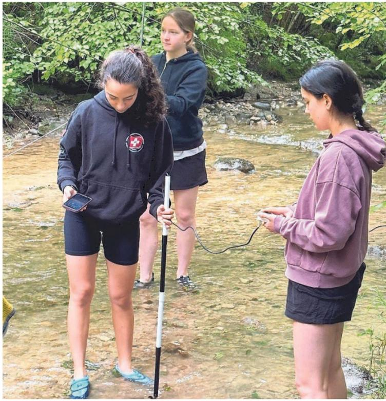
Mit dem Flowmeter wurde der Wasserdurchfluss eruiert.
