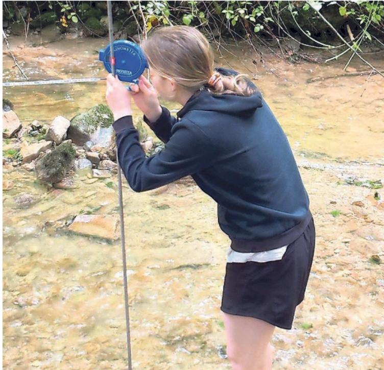
Mit diesem Gerät, einem Gradient, wird das Gefälle erkundet.
