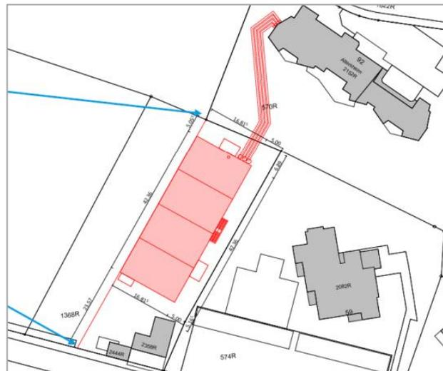
Durch das Areal führen verschiedene Hauptleitungen. Die Neuplanung führt unweigerlich auch dazu, Werkleitungen neu zu verlegen oder zu ersetzen. Verlegungen von Hauptleitungen sind kostenintensiv. Die Teilnehmenden sind angehalten die Eingriffe namentlich bei den Hauptleitungen auf das Notwendige zu beschränken.
